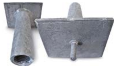
依据DIN EN ISO 9227对大量部件进行了长达1,440小时的盐雾试验，未生成锈，由此满足DIN EN ISO 12944防腐等级C5-M所规定的耐受时间。该试验结果也成为说服风电厂制造商采用这些部件的有力论据。
